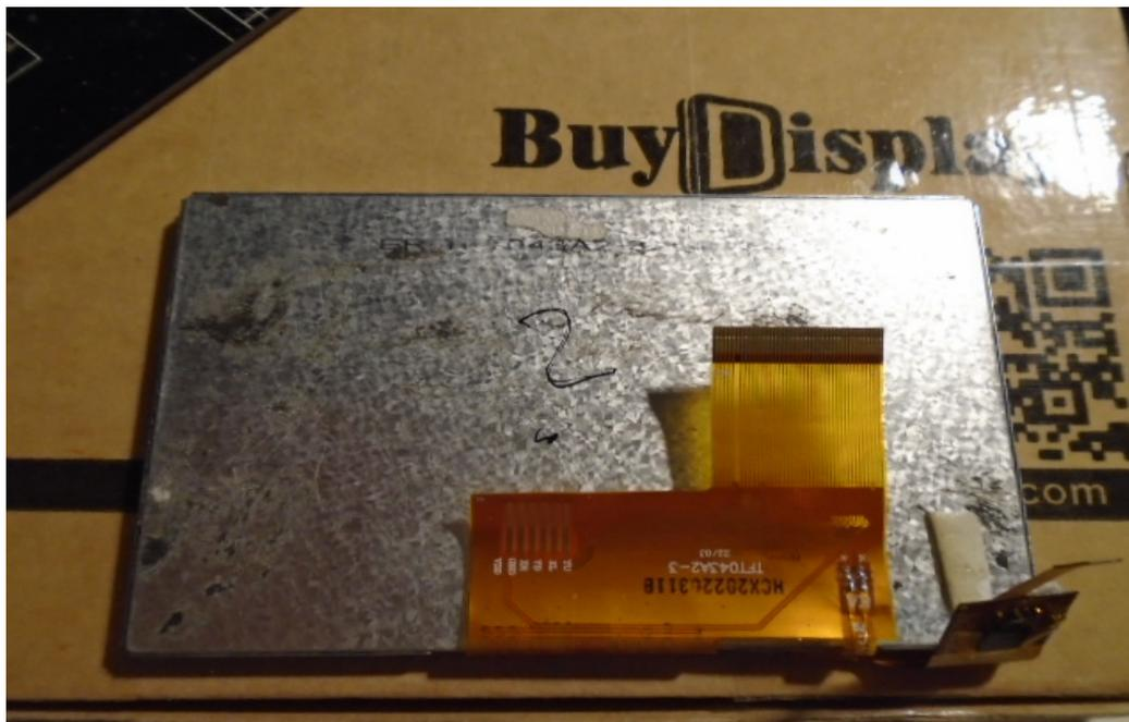
Pantalla TFT lado de conexiones al circuito impreso
