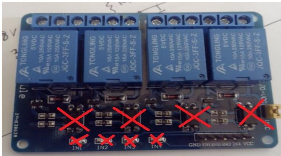
Una vez quitados los componentes señalados deberá de puentear los pads de los 4 leds smd. También deberá de hacer los puentes de los pads de los optoacopladores y de los LED, como puede ver en la siguiente imagen.
