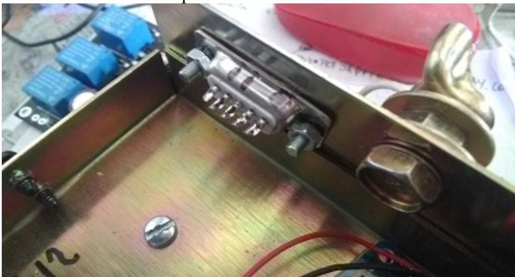
Suelde los cables que irán desde el circuito impreso marcado como 2,3,5 junto al circuito integrado a las patillas del conector RS232, 2, 3 y 5.
