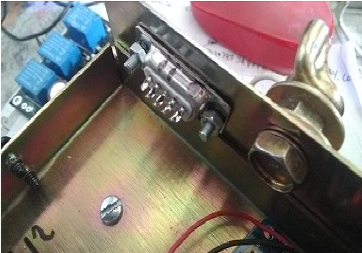
Realice los orificios necesarios en la chapa para fijar el arduino y la placa Kit Visual Rotor Universal.
