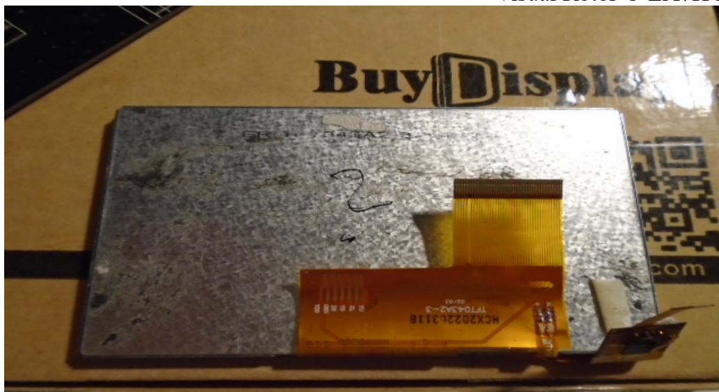
Ecran TFT côté connexions au circuit imprimé
