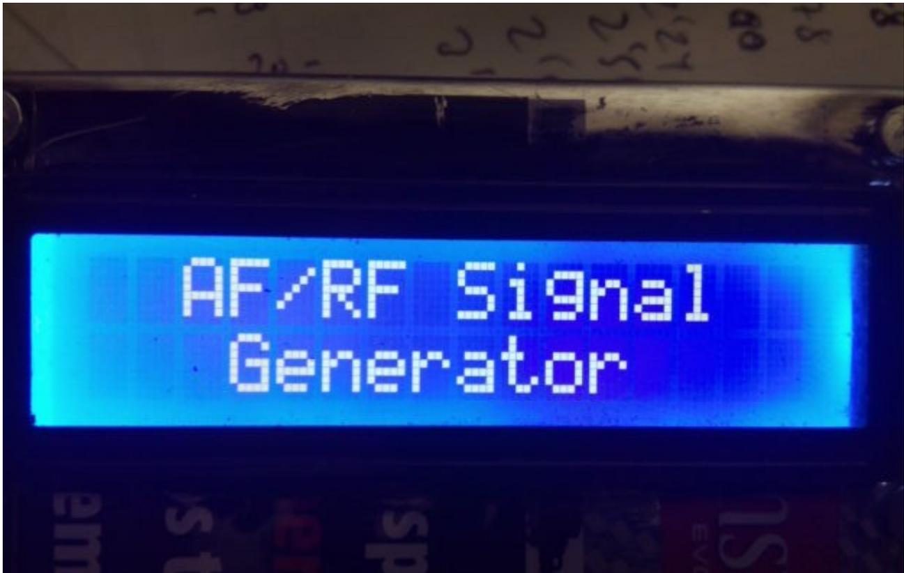
AF/RF Generador de señal es un simple y util circuito creado para Arduino Uno o Arduino Pro Mini 16Mhz, junto una pantalla de LCD de 16X2 con I2C, un DDS con AD9850 o AD9851, un conjunto de 8 atenuadores y un encoder que permite hacer todas las funciones necesarias sin usar ningún pulsador adicional, para generar señales entre 20Hz y 32Khz para el modo AF y entre 100Khz y 40 o 71 Mhz según el DDS utilizado para el modo RF.
