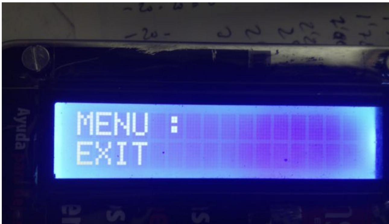
La primera función que le aparece es **EXIT** (SALIDA). Permite la salida del Menú y volver al funcionamiento normal. Si vuelve a pulsar hacia adentro el encoder saldrá del modo Menú. Si gira el encoder hacia la derecha o la izquierda le irán apareciendo las demás opciones del menú.
