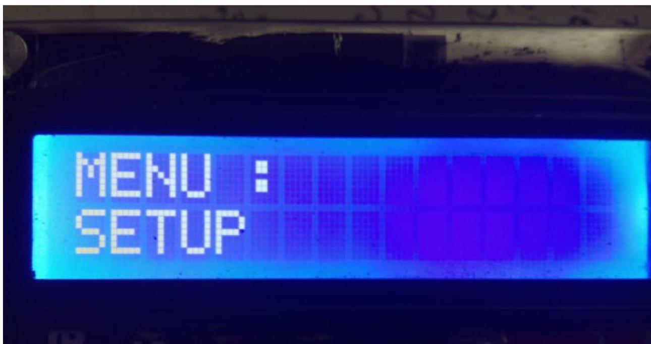
La función **SETUP** permite cambiar varios parámetros del Generador. Una vez seleccionado pulsando hacia adentro el encoder nos aparecen las siguientes opciones:
