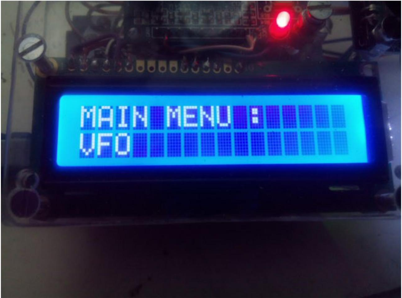
La función **VFO** , permite seleccionar que VFO usar, si es VFO A o VFO B. Pulsando hacia adentro el DIAL ,aparecerá VFO A, si gira el mando DIAL ,le aparecerá VFO B .Para seleccionar el VFO deseado vuelva a pulsar hacia adentro el DIAL y quedará seleccionado dicho VFO y saldrá del modo menú, volviendo a su funcionamiento normal. Si ha seleccionado el VFO A en la pantalla le aparecerá A , si seleccionó VFO B, en la pantalla aparecerá B.
