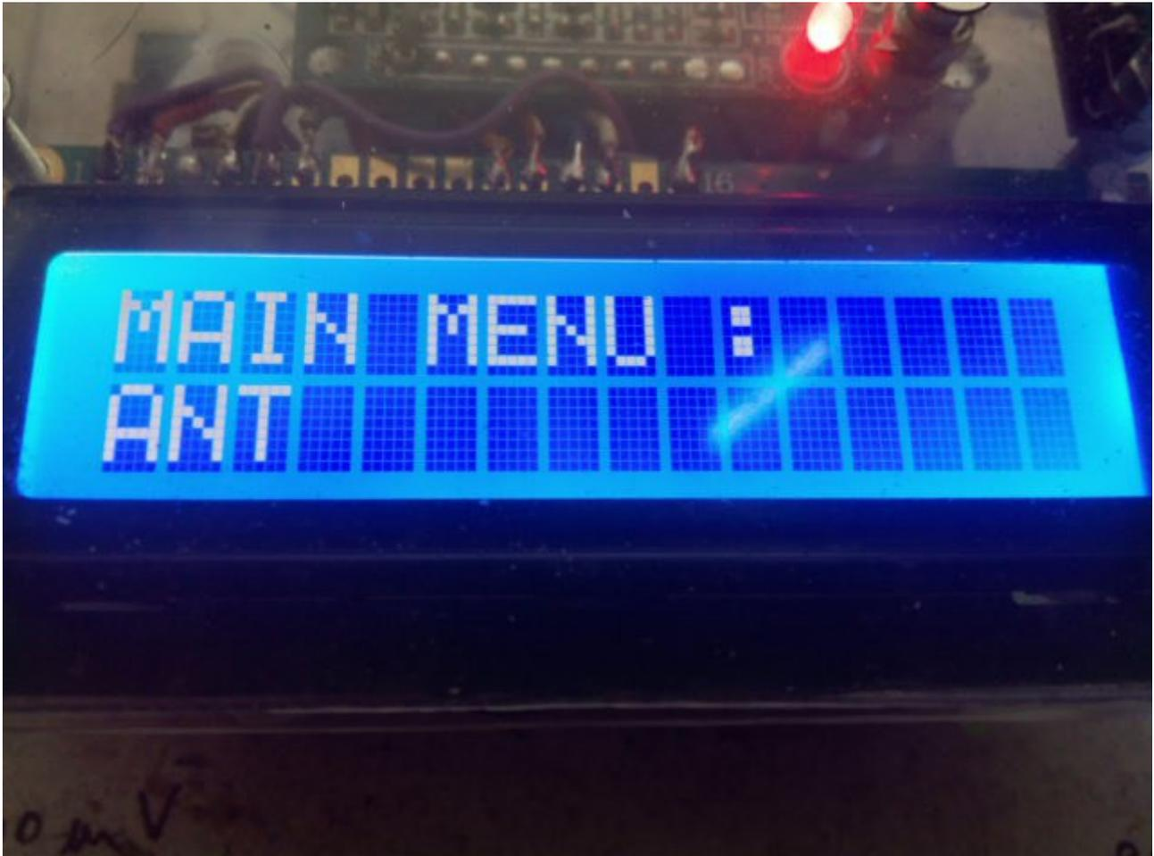
La función **ANT** (ANTENA) ,le permite cambiar entre Antena 1 y Antena 2. En la pantalla le aparecera un icono de una antena Yagi indicandole Antena 1 o Antena 2. Pulsando hacia adentro el mando del DIAL, girando hacia la izquierda o la derecha,le permite seleccionar entre ANT 1 y ANT 2. Pulsando una vez más el mando DIAL quedata seleccionada la Antena elegida.
