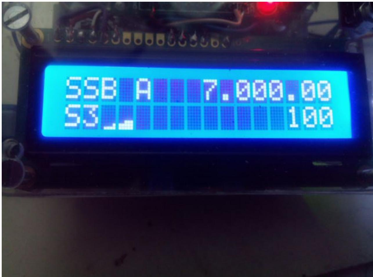
Super-Vfo es realmente un programa creado para Arduino Uno o Arduino Pro Mini 16Mhz, junto una pantalla de LCD de 16X2, un DDS con AD9850 o AD9851 y un encoder que permite hacer todas las funciones necesarias sin usar ningún pulsador adicional, solo el del encoder, usandolo como un VFO.
