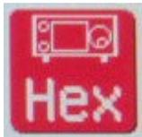
**Icom Hex.** : Permite cambiar la dirección hexadecimal que usa cada transceptor Icom para cuando MAB se encuentra en modo automático.
